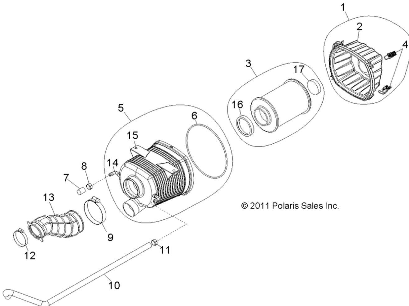
СПИСОК ДЕТАЛЕЙ ДЛЯ "ENGINE AIR INTAKE SYSTEM -
