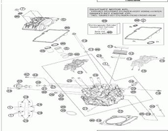
Головка блока цилиндров (передняя)
