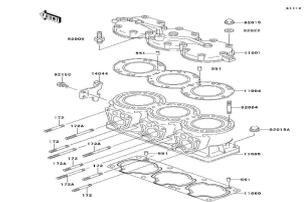
Головка блока цилиндров и цилиндр
